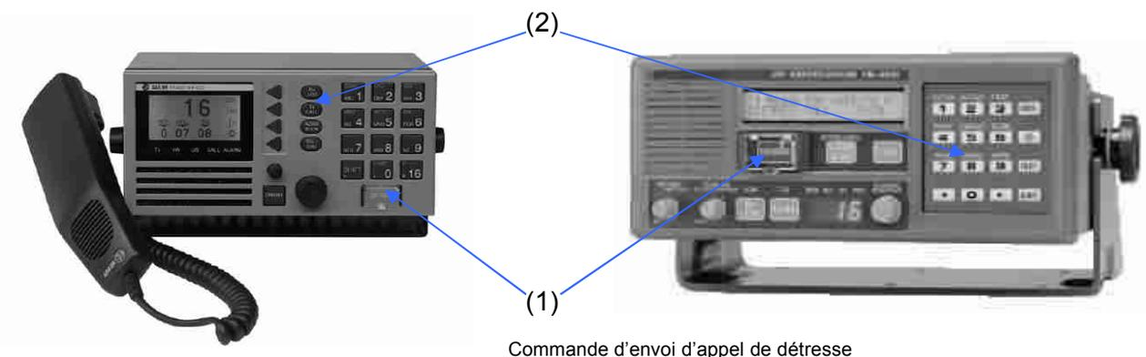
Les constructeurs ont développé, pour les navires non soumis aux règles internationales, des modèles plus simples : les *VHF ASN de classe D*.
