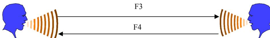
*Exploitation semi-duplex* : l'une des extrémités de la voie (en général, station de navire) est exploitée en mode simplex ; l'autre extrémité (en général station terrestre) est exploitée en mode duplex. Il n'y a donc pas, pour l'utilisateur d'une station de navire, de différence essentielle entre une voie semi-duplex et une voie simplex.
