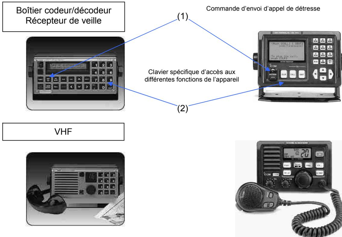
De plus en plus, les constructeurs intègrent les modules VHF, codeur/décodeur et récepteur de veille dans le même boîtier. On trouve donc des ensembles identiques à ceux ci-dessous qui se différencient d'une VHF classique par la présence :
